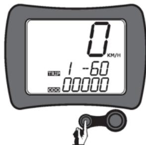
Premete il tasto “**Mode**” per regolare la seconda cifra sul valore 60: il valore corretto per visualizzare sul cruscotto una velocità realistica è, quindi, 1-60. Portate ora la chiave su “**OFF**”, il cruscotto ora riprogrammato visualizzerà dei valori di velocità compatibili con quelli effettivi.
