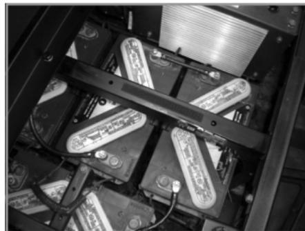
quale è fissato semplicemente con agganci ad incastro come quelli mostrati in figura. Questa operazione può essere eseguita per poter accedere al gruppo batterie ed effettuare interventi di verifica e manutenzione.
