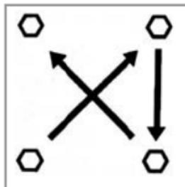
Reinstallate la ruota riparata seguendo le operazioni inverse e serrando i dadi alla corretta coppia di serraggio. Verificate la corretta pressione di gonfiaggio di tutti i pneumatici. Dopo 50 km circa ricontrollate la corretta coppia di serraggio dei dadi ruota.
