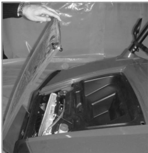
Sollevate quindi il fondo del portapacchi anteriore che costituisce i coperchio del vano di carico, ponendo attenzione alla chiusura al corretto posizionamento delle manopole. Il portapacchi posteriore è scoperto e facilmente accessibile.
