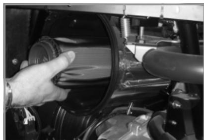
Rimuovete completamente il gruppo filtro. Con delicatezza rimuovete il prefiltra esterno. Lavate il prefiltra con acqua tiepida e sapone neutro, fatelo asciugare **SENZA STRIZZARLO** lontano da fonti di calore. Soffiate **DALL'INTERNO VERSO L'ESTERNO** l'elemento filtrante con un getto di aria a bassa pressione o sostituitelo se necessario.
