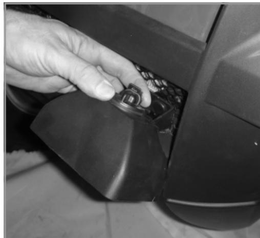
anteriore del veicolo. Ruotare di 90 gradi in senso orario la cuffia in plastica dove è alloggiata la lampadina, scollegare la lampadina facendo attenzione a non scollegare i fili. Sostituire la lampadina facendo attenzione a re inserirla nel corretto verso di montaggio.
