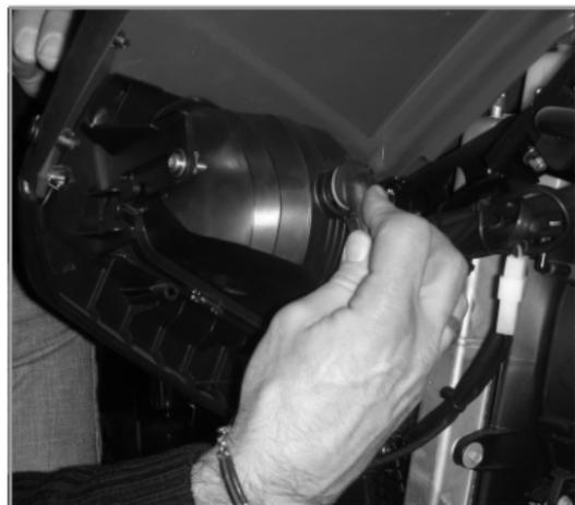
alloggiamento. Per la lampada anabbagliante, ruotare in senso orario la cuffia in plastica dove è alloggiata la lampadina, scollegare la lampadina facendo attenzione a non scollegare i fili. Sostituire la lampadina facendo attenzione a re inserirla nel corretto verso di montaggio.
