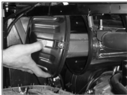
Pulizia del filtro aria: aprite la cassa filtro posta nella parte posteriore sinistra del veicolo, spostando le clips sul coperchio. Sfilate con attenzione il coperchio ed osservate il contenuto della cassa filtro: se particolarmente piena di sporcizia ed umidità, effettuate una pulizia preventiva dell'interno della cassa con uno straccio. Se notate evidenti ristagni di acqua, smontate lo sfiato inferiore ed evacuate l'acqua prima della pulizia dell'interno.
