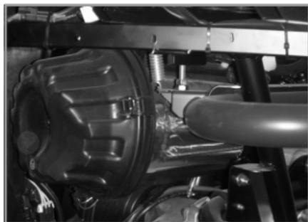
Il vostro quadriciclo è dotato di un filtro aria principale in carta protetto da un pre-filtro aria in materiale sintetico. Per un uso medio, attenetevi alla frequenza di ispezione e di pulizia specificata dal piano di manutenzione periodica, per un impiego su strade polverose effettuate queste operazioni con maggiore frequenza.
