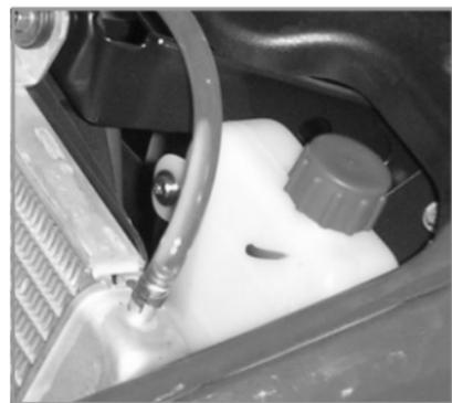
La quantità del liquido di raffreddamento circolante nell'impianto viene gestita automaticamente dall'impianto stesso, a patto che venga garantita una corretta quantità di fluido nell'impianto. Generalmente non si rendono necessari frequenti rabbocchi all'impianto. Nel caso in cui si possa notare un consumo anomalo di fluido di raffreddamento, contattare al più presto un concessionario o rivenditore autorizzato Egimotors.
