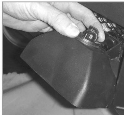
faro installato sulla parte anteriore del veicolo. Ruotare di 90 gradi in senso orario la cuffia in plastica dove è alloggiata la lampadina, scollegare la lampadina facendo attenzione a non scollegare i fili. Sostituire la lampadina facendo attenzione a re inserirla nel corretto verso di montaggio.
